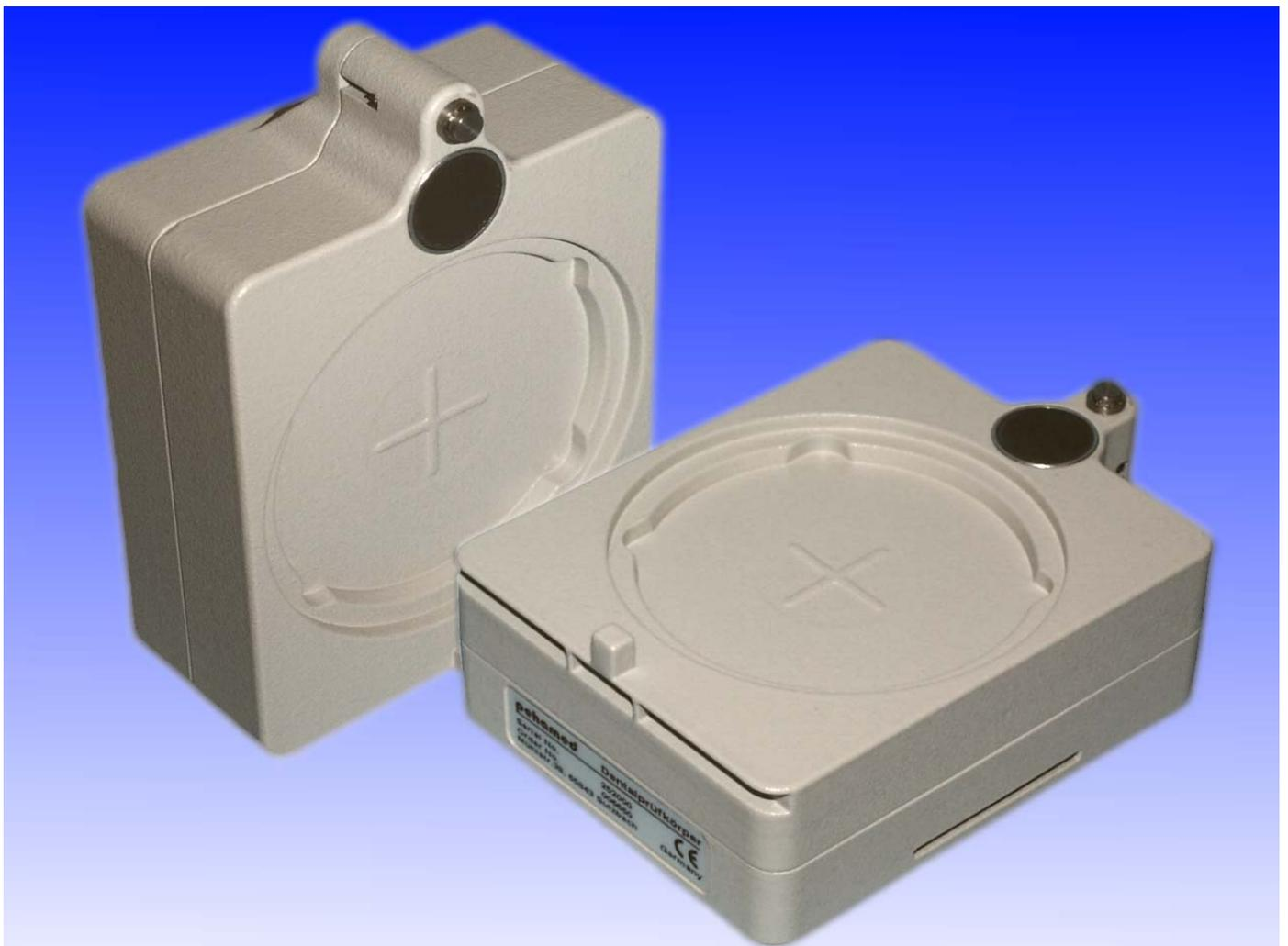
Prüfkörper für die Konstanzprüfung der zahnärztlichen Röntgenaufnahmetechnik gemäß DIN 6868 Teil 5.
